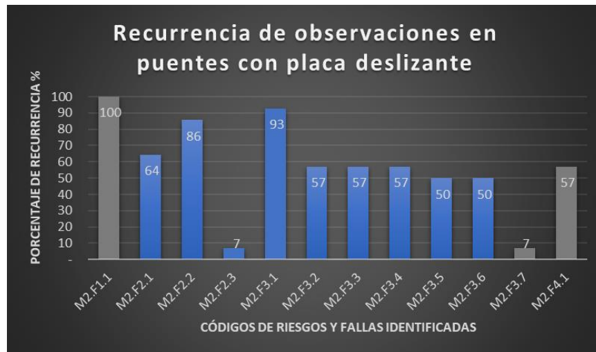
Gráfico 4.1: Recurrencia de observaciones en puentes con cantonera de placa deslizante.
