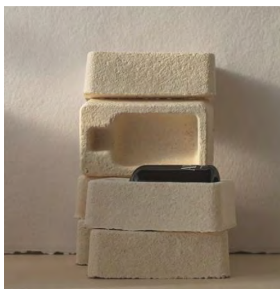
Figura 8. Material en base a micelio de hongos para embalaje producido por la empresa Ecovative
