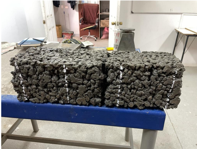
Figura 4.7.2: Rotura tercio central de probeta Fuente: Elaboración propia
