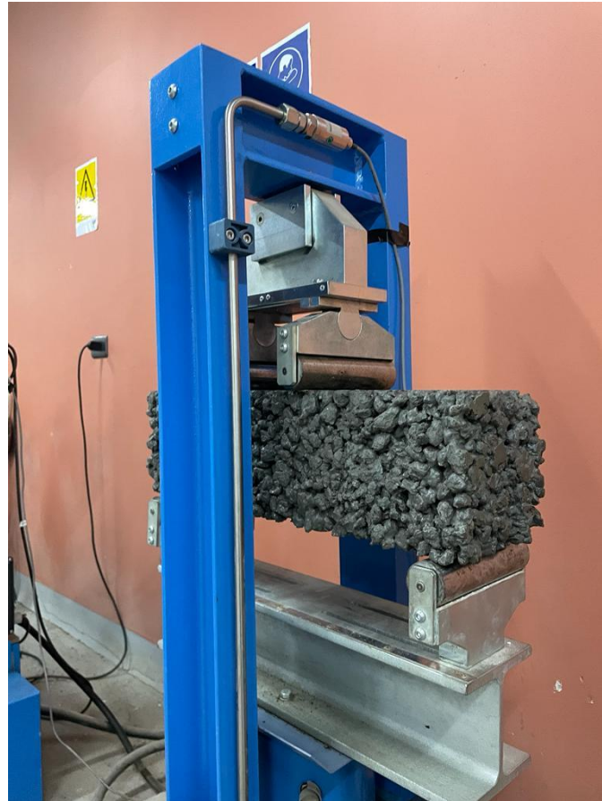
Figura 4.7.1: Ensayo de resistencia a la flexo tracción Fuente: Elaboración propia
