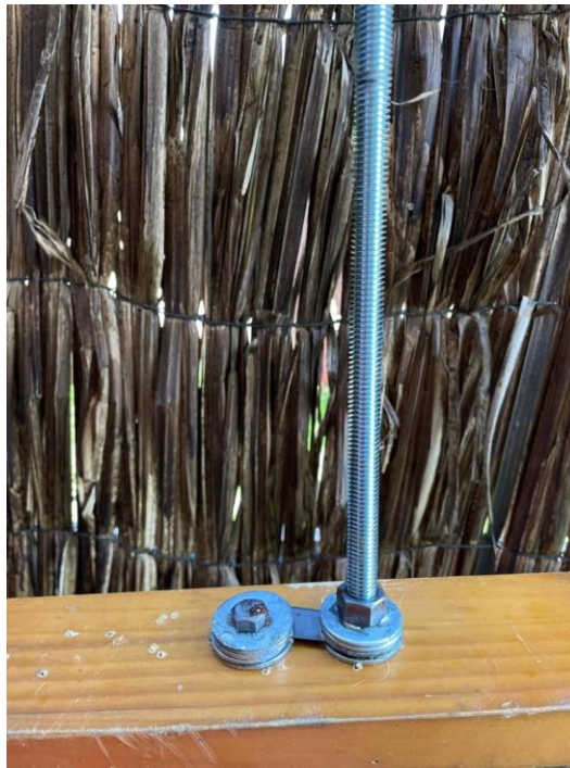
Figura 3.4.4: Herramienta artesanal para obtener tiras de PET Fuente: Elaboración propia
