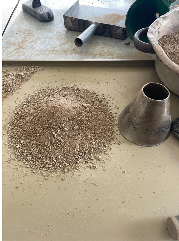
Figura 4.3.1: Asentamiento natural arena Fuente: Elaboración propia
