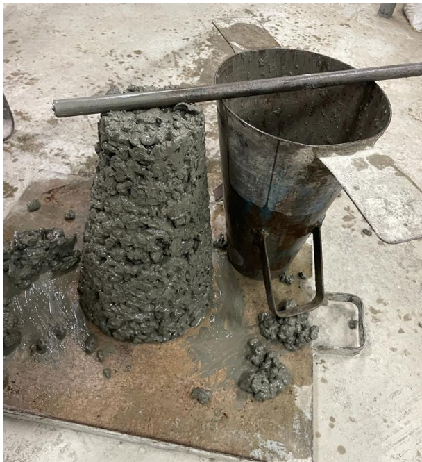
Figura 4.4: Cono de Abrams Fuente: Elaboración propia
