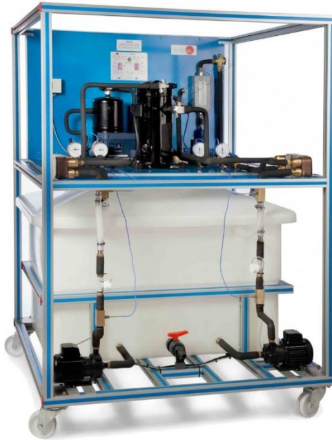
Figura 29: Equipo de desalación por compresión mecánica de vapor.
