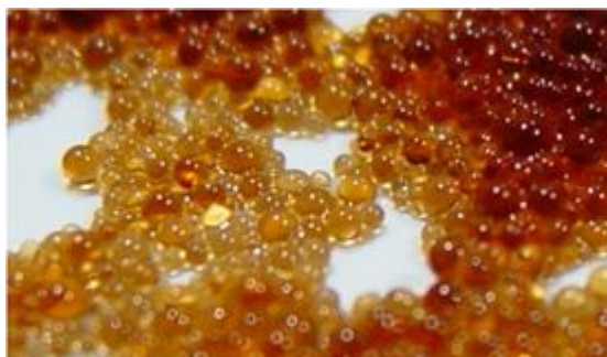
Figura 30: Perlas de resina utilizadas en el tratamiento de agua mediante intercambio iónico 2 .
