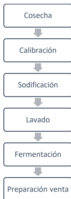
Figura 1: Proceso de elaboración aceituna tipo verde estilo sevillano o español. (Adaptado de: Tapia & Arancibia, 2001; Arancibia, 2006).
