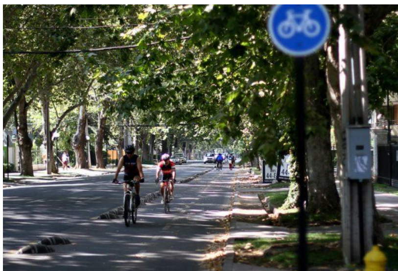
Figura 2-2 Ejemplo de ciclovía segregada
