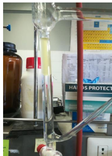
Figura 20: Aceite concentrado en trampa tipo Clevenger
