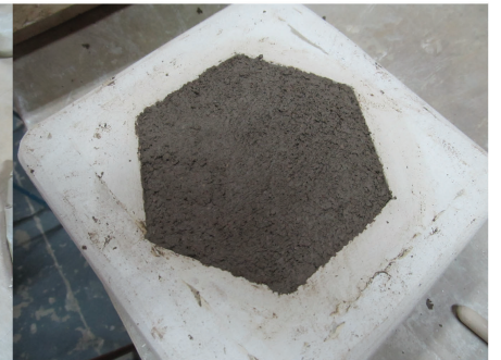
Anexo 5 Construcción de moldes de yeso y conformación de módulo cerámico Hexo.
