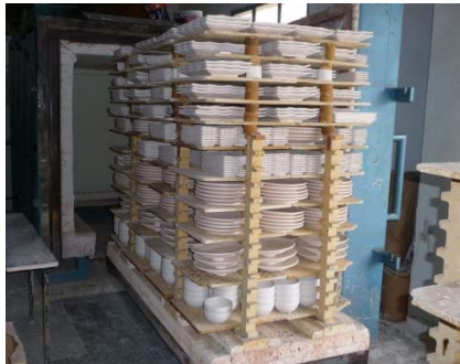
Fig. 15. Carga de loza bizcochada, saliendo de horno industrial. Fuente: http://ceramicaelobo.com
