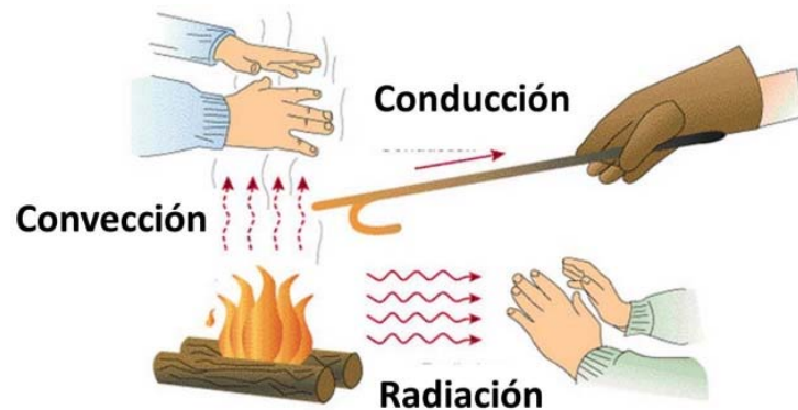
Fig. 11. Si bien una fuente de calor puede transmitirlo de las tres formas a la vez, siempre hay una que predomina.
