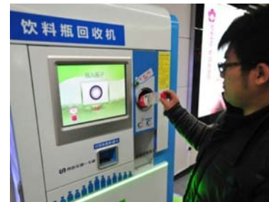
Fig. 6 Dispositivo de recepción de botellas de plástico PET. Empresa Incom.
