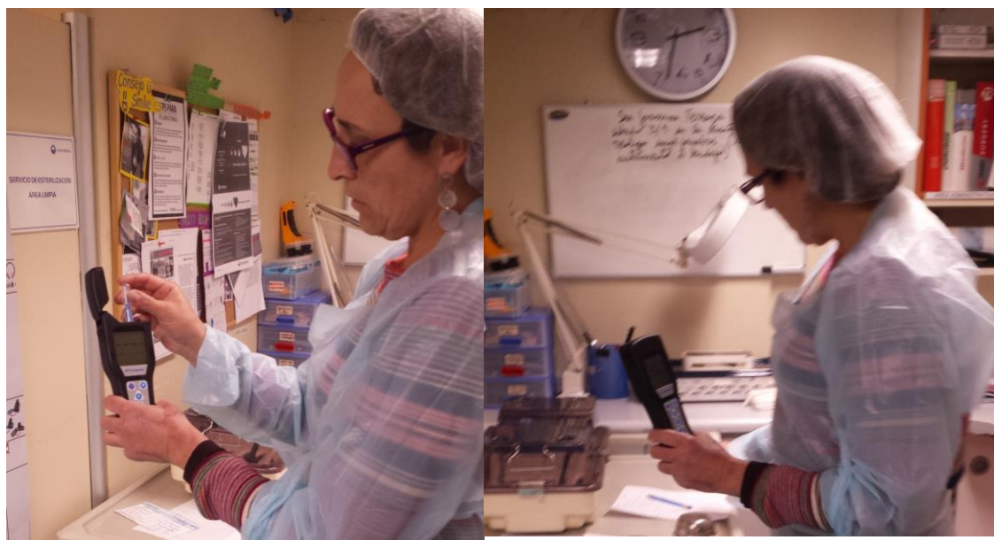
Figura 6: Detección de materia orgánica mediante bioluminiscencia
