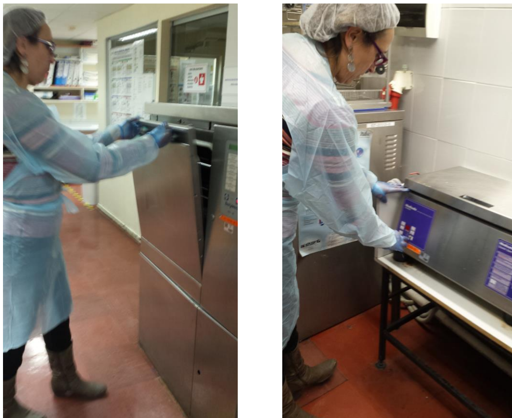
Figura 5: Lavado automático en lavadora descontaminadora (imagen derecha) y lavado ultrasónico (imagen izquierda).
