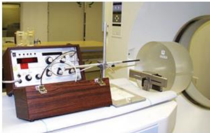
Fig. 17 Cámara de ionización y fantoma de 32 cm de diámetro usado para medir el CTDI.
