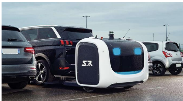
Ilustración 2. 16 Sistema Parking Robot Stanley
