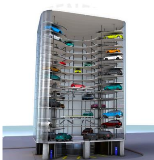
Ilustración 2. 14 Sistema de estacionamiento robotizado
