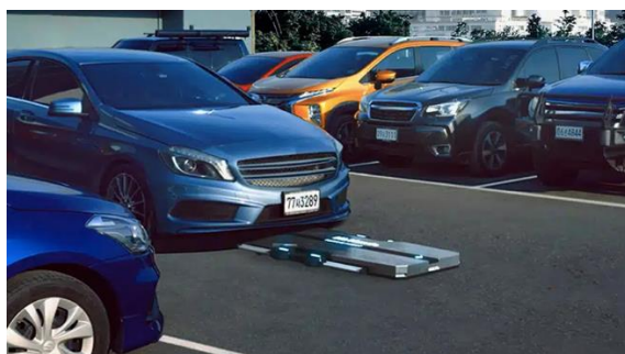
Ilustración 2. 15 Sistema Parking Robot (patinetas)
