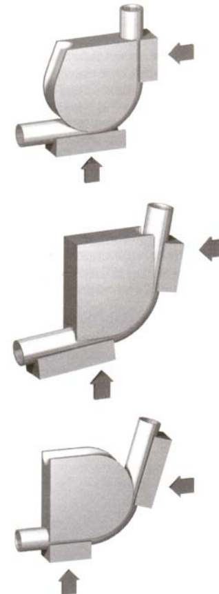
Figura N° 1: sistema de plegado manual de tubos
