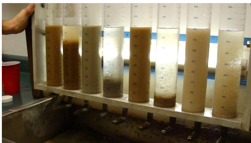
Imagen 2.1 – Pruebas de sedimentabilidad en probetas
