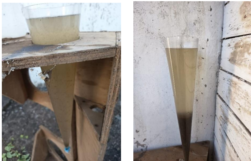
Imagen 9.6 – Ensayos de sedimentabilidad realizados en la PTAS de El Porvenir
