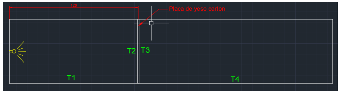
Figura 3.8: Esquema cámara ensayo térmico
