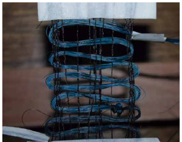
Experimentación en telar de mesa Urdimbre de Crin trenzada y Trama engrosada prolongada con nudos. Fuente: Registro fotográfico propio.
