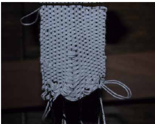
Experimentación en telar de mesa Urdimbre de Crin trenzada, Trama hilo de poliéster. Fuente: Registro fotográfico propio.
