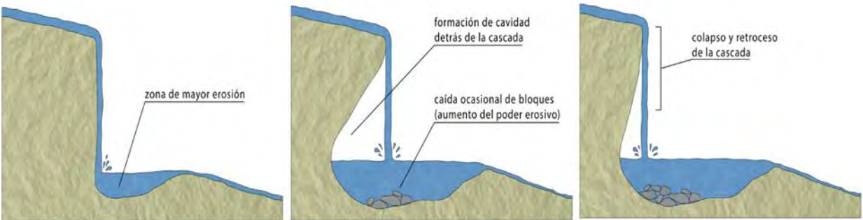
Ilustración 3.11: Esquema del proceso de evolución de cascadas.
