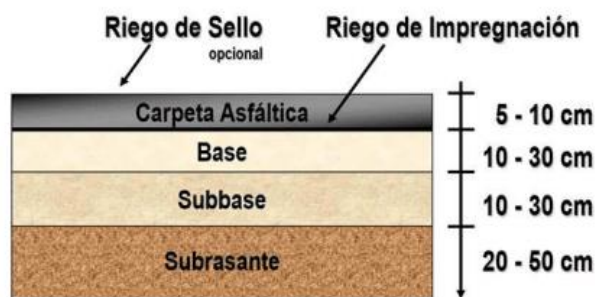
Ilustración 2.1 - Capas Pavimento Flexible Fuente: Construneic 2022
